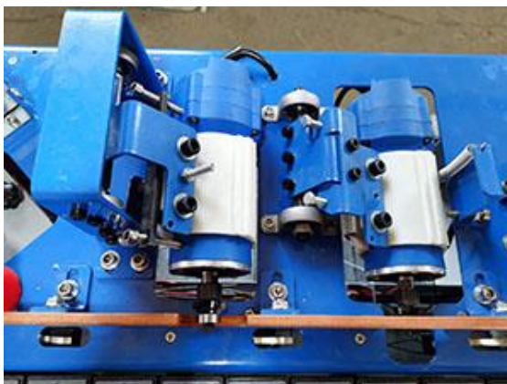
Узел снятия свесов
